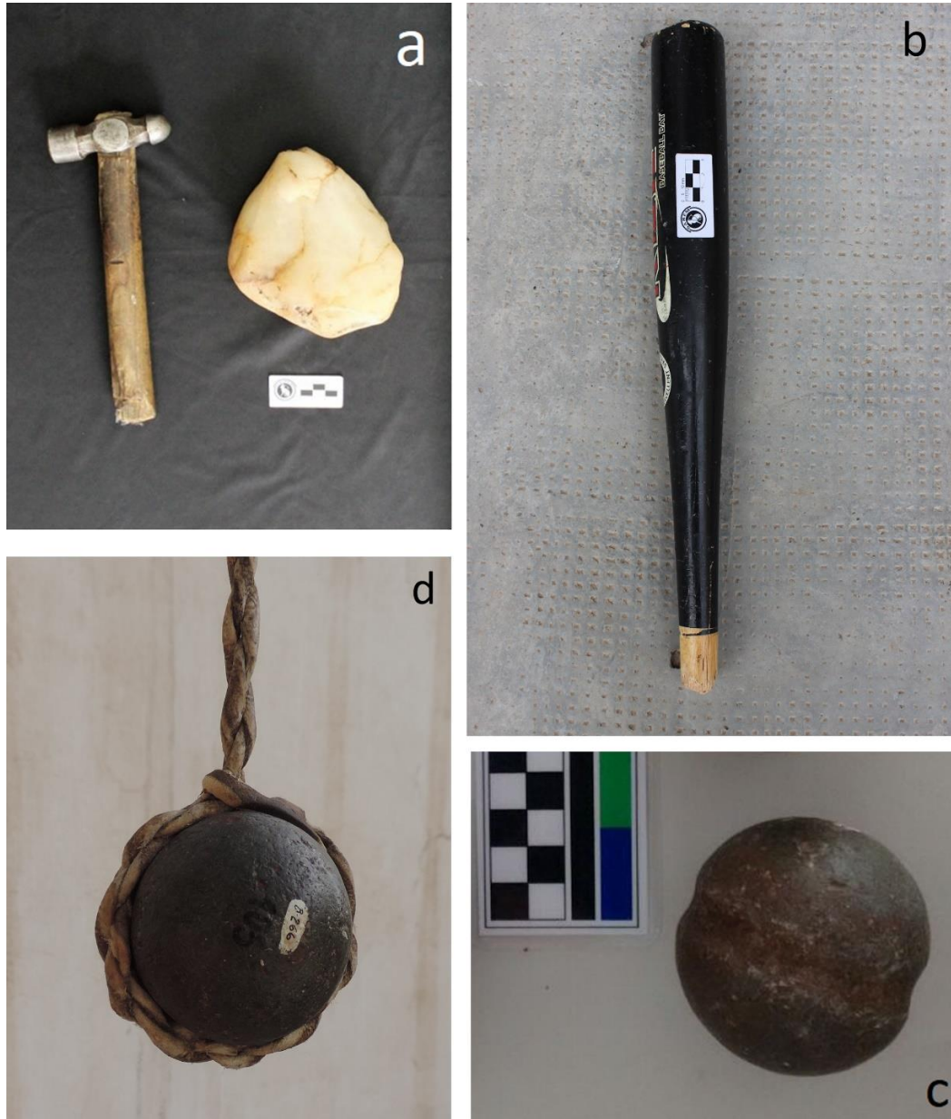
Figura 4.3. Efectores utilizados: a) Martillo y piedra. b) Garrote de madera. c) Boleadora, se puede observar el surco. d) La misma boleadora de andesita sujeta por el tiento de cuero, así se la preparó para el experimento.
